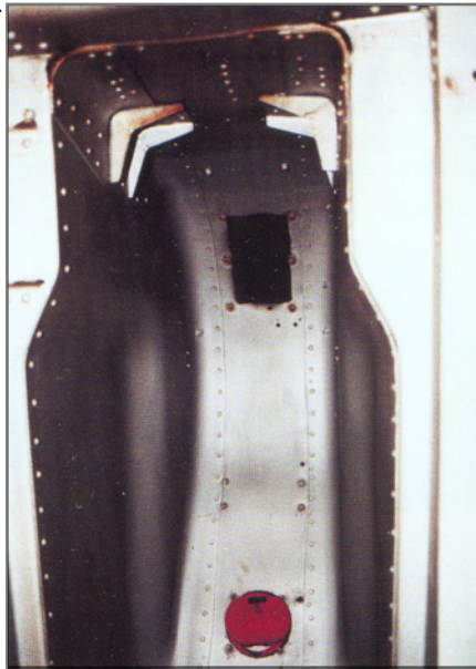
Ниша носовой стойки шасси He 162 из Хендона после реставрации осталась неокрашенной...
