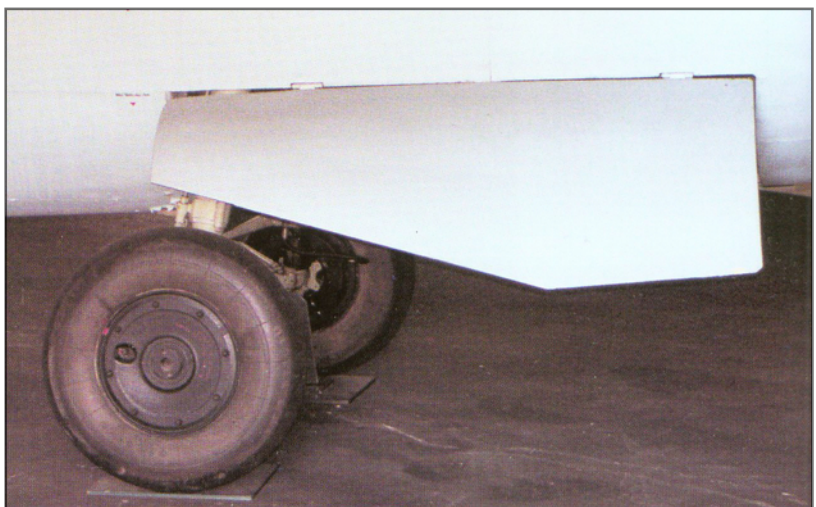
Щитки ниш шасси имели деревянную конструкцию и крепились на простых петлях.
