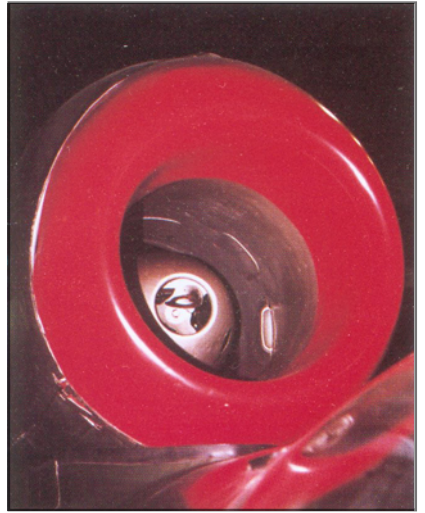
Воздухозаборник двигателя. В центральном конусе видно отверстие для ручного запуска стартера.
