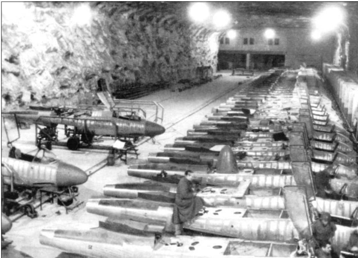
Подземный завод в соляных шахтах Эзер с самолетами дожидаящимися окончательной сборки - в таком виде он был обнаружен американцами в апреле 1945 года. Вдоль стены, перед каждым фюзеляжем, в своем индивидуальном отсеке ожидает установленное катапультное кресло. Учитывая условия в которых он создавался, He 162 является примером технологического совершенства, приспособленного к массовому производству в сложных условиях.
