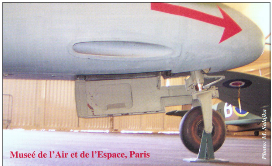
Носовая стойка шасси, вид справа. Хорошо видна конструкция внутренней части щитка.
