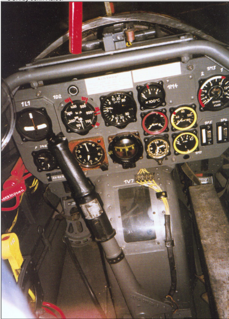
На Хейнкель He 162A-2 Werk Nr. 120223 из парижского музея тщательно восстановлена панель приборов с использованием оригинального немецкого оборудования.
