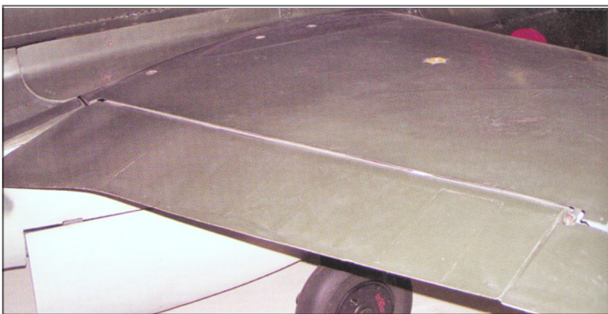
Интересной деталью была сильно отогнутая вниз корневая часть задней кромки крыла.
