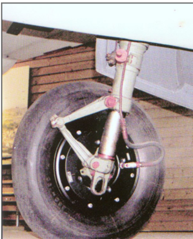
Внутренняя сторона основной стойки шасси. Видна проводка тормозной системы.
