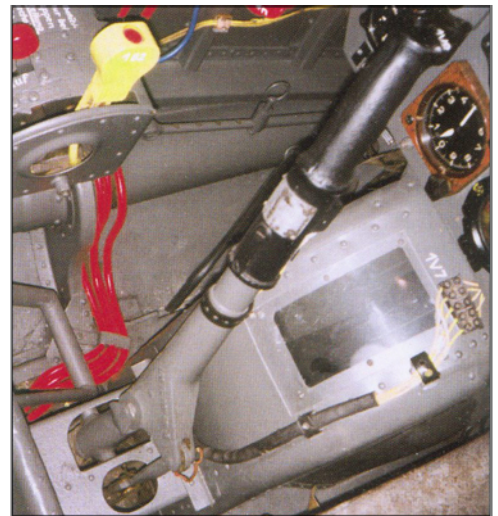
Ручка управления и окно для контроля положения носовой стойки шасси.
