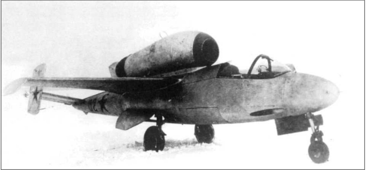
Вид на He 162A-2 «02» с правого борта. Видна антенна радиостанции FuG 16 (или FuG 24a), протянутая от фюзеляжа (правее звезды) до нижней части правой шайбы вертикального оперения. На киле, над звездой, эмблема ЛИИ.
