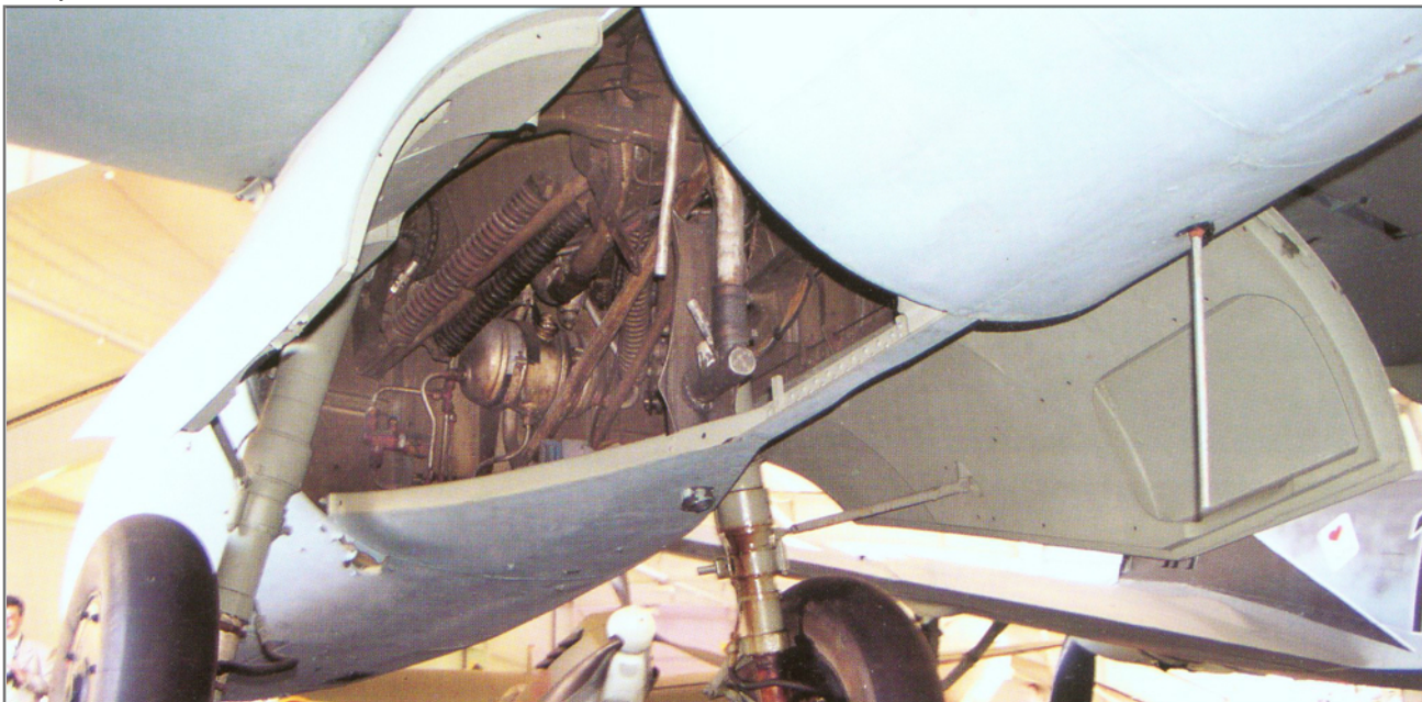
Левая ниша основной стойки шасси. Видна антенна системы опознавания «свой-чужой» FuG 25a.
