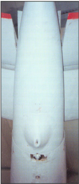
Вид снизу на хвостовой конус. Виден узел регулировки и предохранительная опора.
