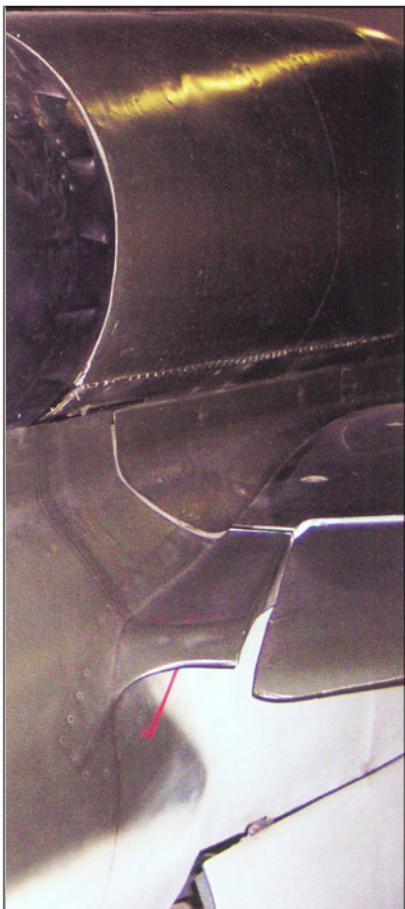
Интересной деталью была сильно отогнутая вниз корневая часть задней кромки крыла.
